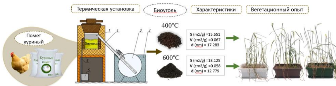
Рисунок 1 – Схема эксперимента с получением биоугля из помета при разных температурах и с внесением его в почву для выращивания пшеницы.
